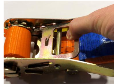
Håndtaket frigjøres ved å trekke i låsemekanismen.
