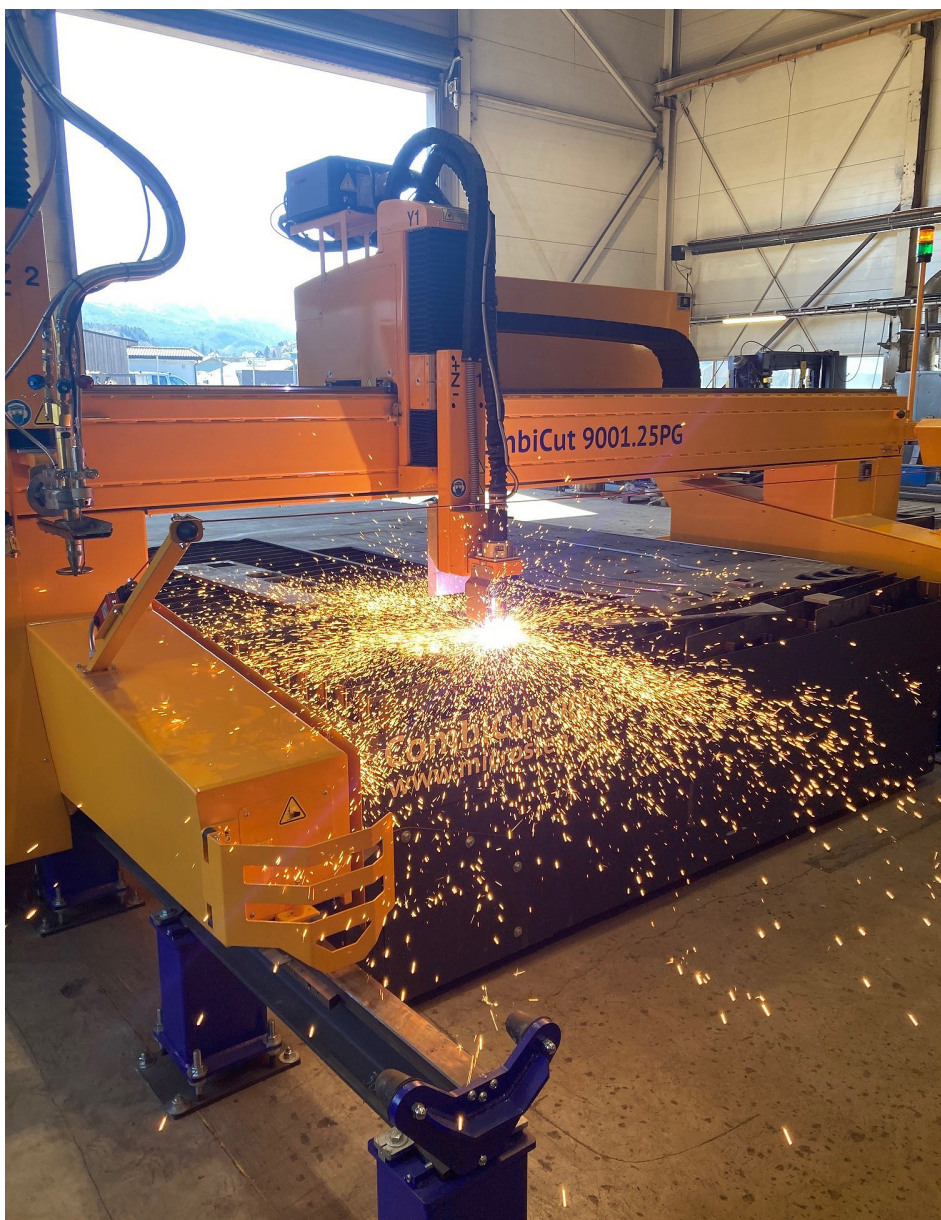
MicroStep CombiCut med Hypertherm XPR300 Optimax strømkilde er en kraftig maskin beregnet for kontinuerlig drift.
