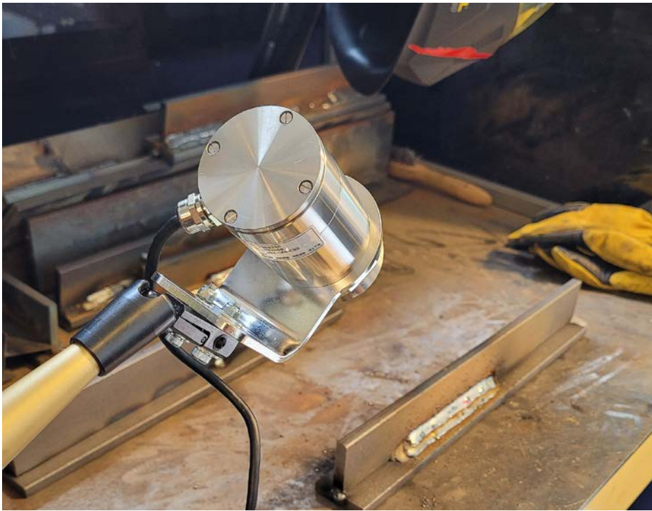
Her er en tilleggssensor som brukes til å måle temperaturen for få oppgitt T8/5.
