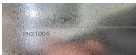
MicroStep-maskinen er utrustet med lasermerkeenheter, noe som åpner for full sporbarhet og merking av sveisepunkter eller montasjeanvisninger. Foto: Joppe Næss Christensen
