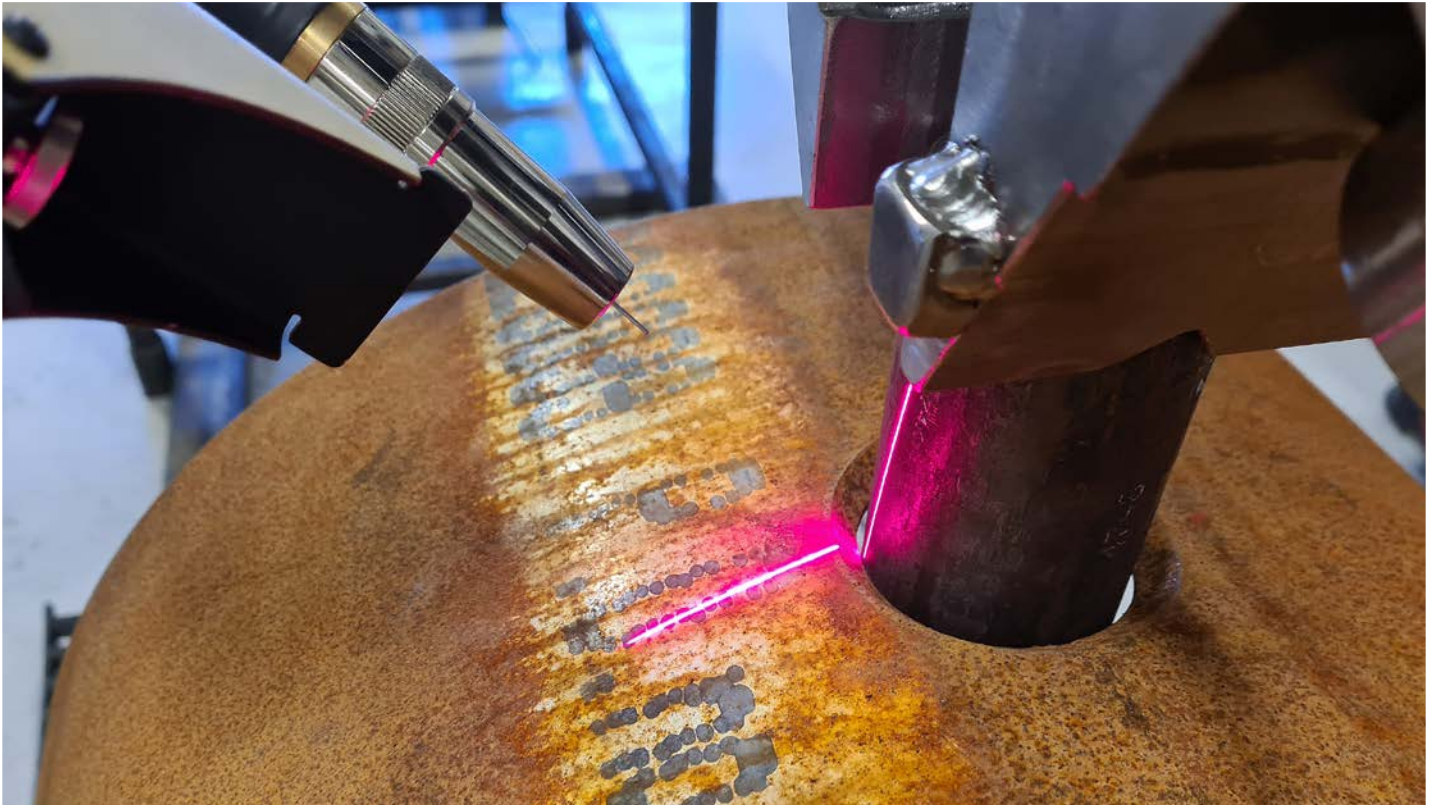
Robotcellen som er under ferdigstilling har en meget avansert og presis fugefølgelaser som gir høy presisjon ved sveising, også av aluminium. Foto: Joppe Næss Christensen
