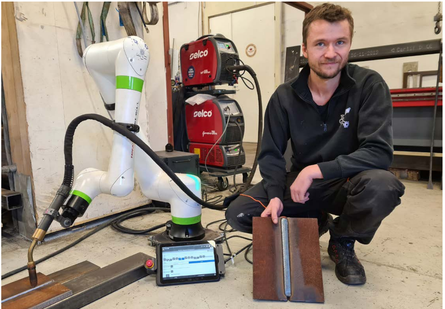
EGH har tett samarbeid med EIVA-SAFEX på sveising. På bildet vises eksempel på pendelsveising med Fanuc cobot. – Vi er dypt imponert over hvor stabil og presis denne coboten fra Fanuc er, uttaler Einar Heslien hos EGH AS. Foto: Joppe Næss Christensen
