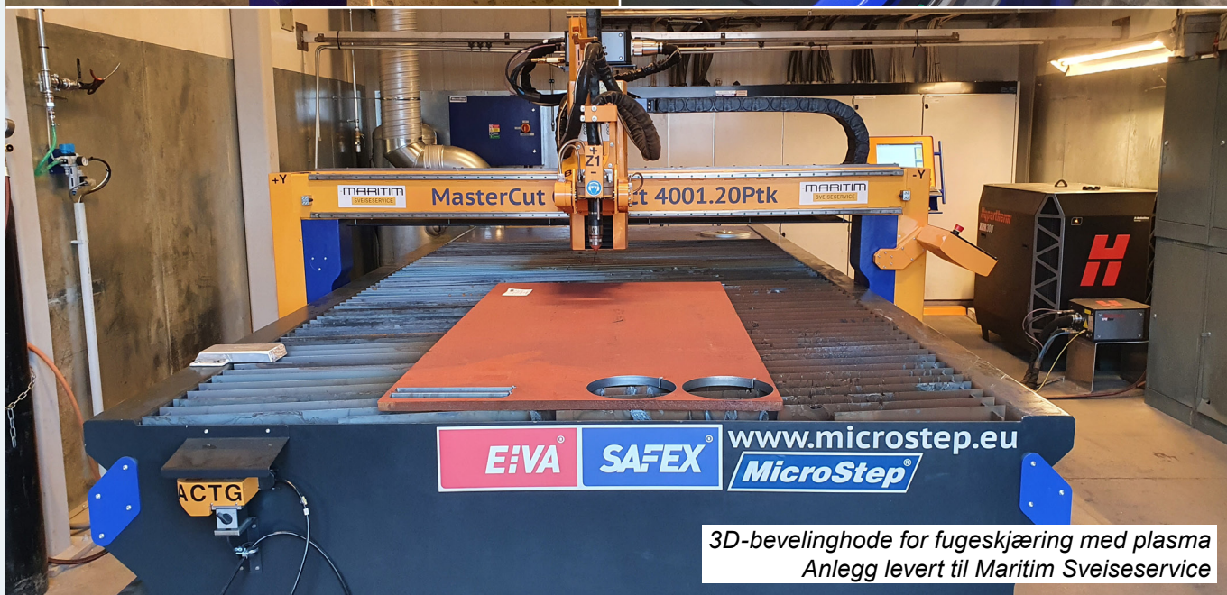
Rettskjæring med plasma og gass Anlegg levert til MCE
