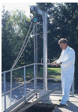
Vekt kun 37 kg. Kan med letthet flyttes til andre stasjoner med faste fotplater. Kranen (inkl. fotplate og festebolter) er i rustfritt stål INOX 304 L. Dette er ideelt til bruk i aggressive miljøer med mye korrosjon.
