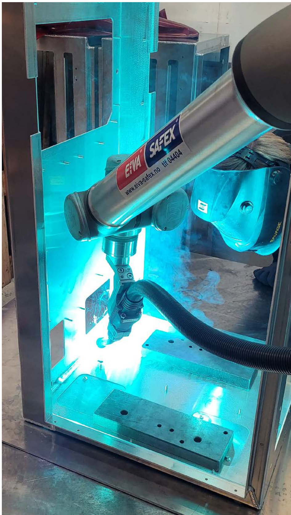
Robotsveisingen avlaster manuell sveising og effektiviserer produktiviteten. Foto: Kristoffer Lindh.
