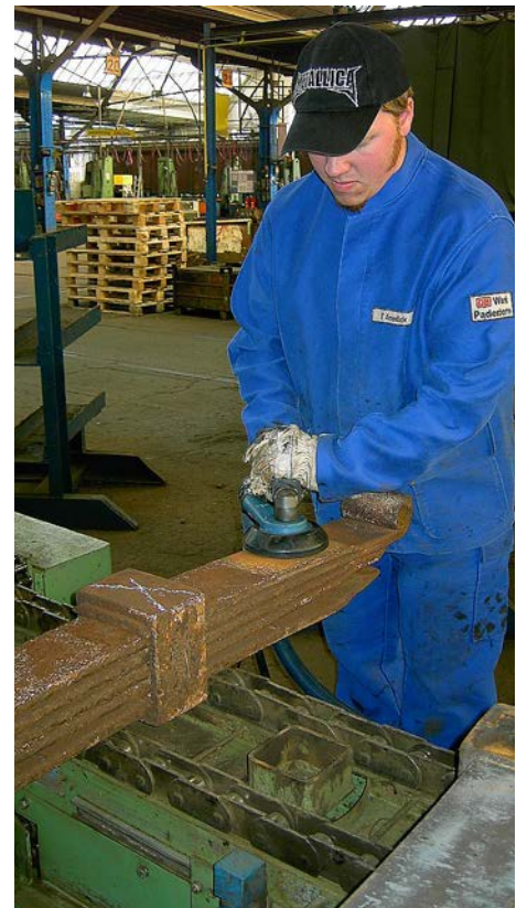
Høyvakuu avsug rett ved kilden gir bedre arbeidsmiljø, som under en slipeoperasjon. Foto: Reglo
